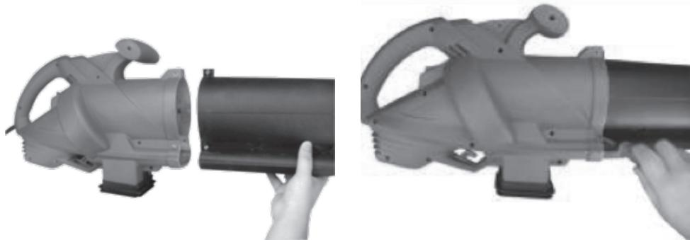
**2-** Insertar el tubo inferior dentro del tubo superior y empujar hasta que estén firmemente unidos. A continuación, apretar los tornillos.
