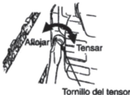
**6.** Ajuste firmemente las tuercas, manteniendo la espada orientada hacia arriba (12 – 15 N·m). Verifique luego que la cadena se mueva fácilmente y que la tensión de la misma sea correcta, moviéndola con la mano. En caso de que sea
