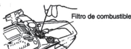
(b) Desmonte o filtro e lave todas as peças com gasolina. Se necessário, substitua-o por um filtro novo
