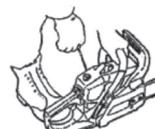
**NOTA:** Ao arrancar o motor imediatamente depois de o ter parado, coloque o botão do estrangulador na primeira posição (estrangulador aberto e alavanca do acelerador na posição de arranque).
