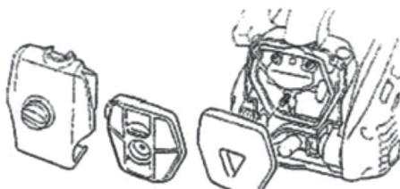
**NOTA:** Al instalar el filtro principal, verifique que las ranuras en el bote del mismo queden perfectamente calzadas en las proyecciones de la cubierta del cilindro.
