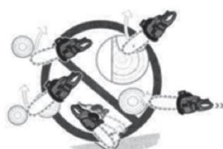
Esta motosierra está equipada con un freno de cadena, el cual detiene el movimiento de la cadena en el caso de que se produzca un contragolpe durante la operación de la unidad. Verifique el funcionamiento del freno de la cadena siempre antes de comenzar a utilizar la unidad haciendo funcionar el motor a velocidad máxima durante 1 a 2 segundos y empujando luego el protector de lanterno hacia adelante. La cadena debe detenerse inmediatamente aun mientras el motor funciona
